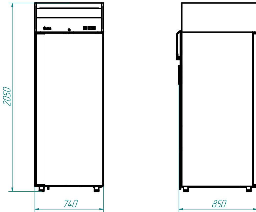
Шкаф холодильный типа ШХ-0,7 (ШХн-0,7;ШХс-0,7) с верхним расположением агрегата предназначен для хранения пищевых продуктов в охлаждённом или замороженном состоянии на предприятиях общественного питания и торговли.
